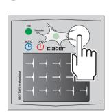
que termine, pulse varias veces el botón del programador para seleccionar el estado deseado: riego automático activo (parpadeo del led en azul) o riego automático no activo (parpadeo del led en rojo).
