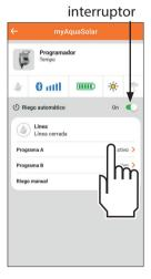
(3) Para cada programa, se pueden ajustar la hora de inicio, la duración del riego (de 1 minuto a 3 horas y 59 minutos) y los días de riego semanales. Si desea que el programa configurado esté inmediatamente operativo, asegúrese de que el interruptor esté activado. Pulse el botón Guardar y volver para confirmar los ajustes.
