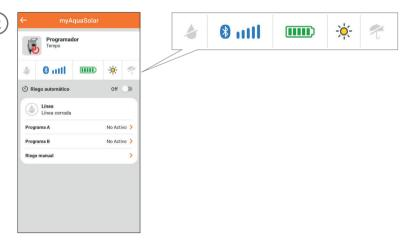
anormal. Si se sospecha que el programador se ha apagado, para actualizar automáticamente la fecha y la hora, acérquese con el smartphone a menos de 10 m y, tras comprobar que el icono de Bluetooth® esté en azul, pulse su pestaña de producto en la app.
